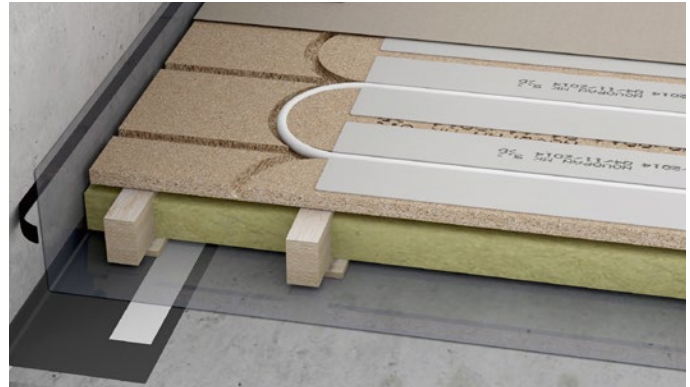
Figur 4 Klimagulv med kantstrø højst 40 mm fra væg og ekstra strø under vendespor.
